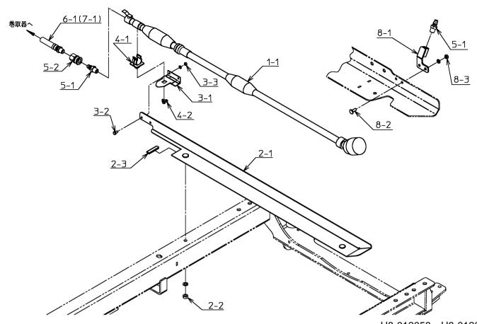
H8-012058 ~ H8-012077 <u>品名</u> 手散布ノズル 手散布ノズルベース 個数 備考 4C23515-00 1-1 2-1 3B12311-00 2-2 2 SW付 020-3050810S 六角ナット レギュラートリム ホルダベースマトメ 1 2-3 093-0242004 4M27426-01 1 3-1 六角ボルト 3-2 010-0030510 2 2 1 3-3 六角ナット SW付 020-0030520S ロッドホルダ 4-1 4C23362-00 1 4-2 4B23899-00 プレート ァレー・ <u>クイックカップリング</u> クイックカップリング スプレーホース スプレーホース 4C27904-00 5-1 5-2 4C27905-00 1 6-1 1 巻取器20m 096-3213020 巻取器30m 7-1 096-3213030 1 ハフレーホーへ カップリングホルダマトメ <u>溶接ボルト</u> 六角ナット 8-1 4M32518-00 018-0150616 8-2 SW付 8-3 020-3050610S
