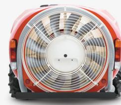
湾曲送風ファン・風洞波形静翼を採用し大風量と静音性を両立
