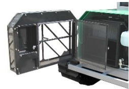
メンテナンス性の向上した 後部ラジエーターカバー
